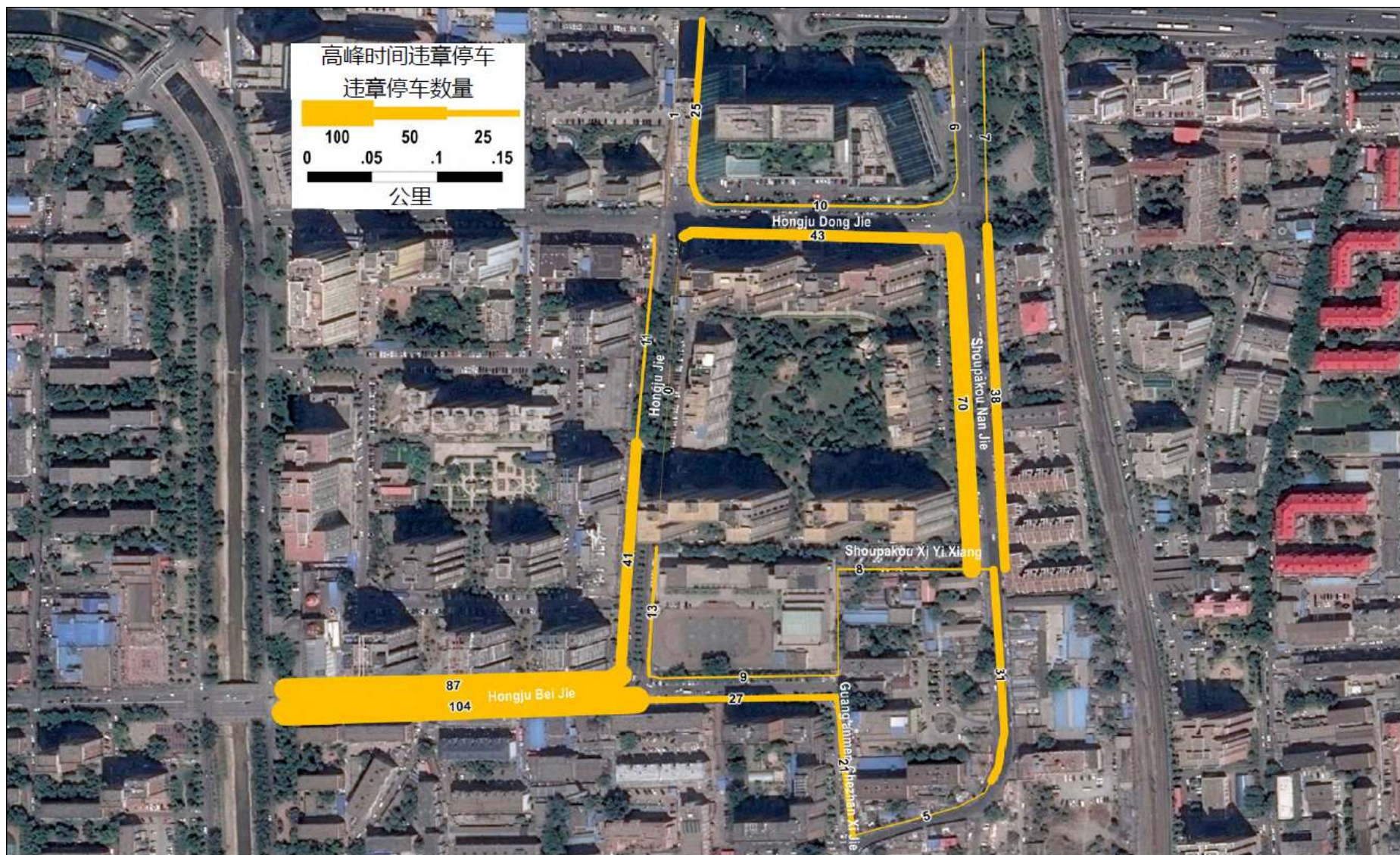
上图：在晚上8点即停车需求达到最大的时候，违章停车的现象非常普遍，尤其是在红居北街和手帕口南街。尽管道路条件允许，红居北街也没有合法的路内停车。在手帕口南街，大部分的违章停车都在人行道上。这里的停车应被引导使用朗琴国际和朗琴园的地下停车场的空置车位。
