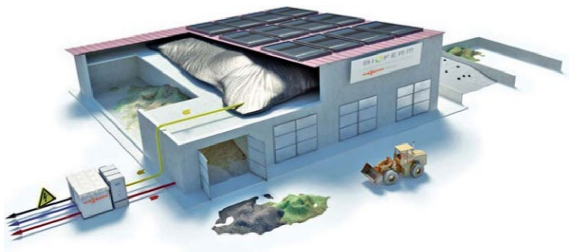
图 3-6 BIOFERM 公司干发酵工艺
